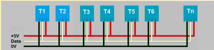
Certaines sonde silo numérique ne comporte que 2 fils (elle fonctionnent dans un mode appelé "parasitic power", le 5V et le 0V sont ponté en interne) ce type de raccordement réduit la distance admissible entre la sonde et l'électronique. la longueur typique maximum est de 200 mètres en câble 3 fils blindé.
