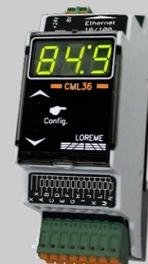
Le CML36N est une centrale de mesure interconnectable en bus, permettant la mesure de température par l'intermédiaire de sonde silo de type numérique. Un bus peut concentrer 32 sondes silo de 46 éléments de mesure sur la liaison Ethernet
